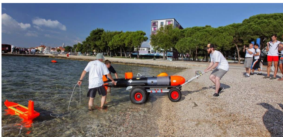
Slika 2.16 ATLAS Elektronik SeaCat AUV na BTS2014 radionici u Biogradu (190kg)
