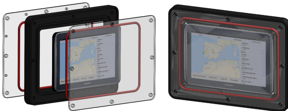
Slika 4.30 Kućište za tablet na BUDDY autonomnom robotu
