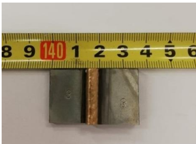
Slika 37 Naličje zavara uzorka 1
