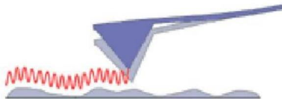
**Slika 20. Princip beskontaktnog načina rada AFM-a [24]**
