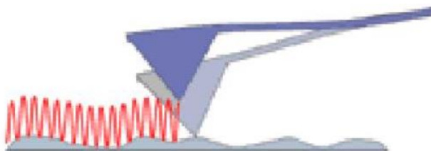
Slika 18. Princip isprekidanog načina rada AFM-a [24]
