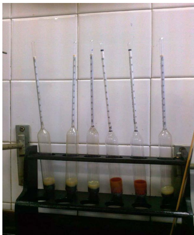
Slika 11. Areometri za mjerenje gustoće
