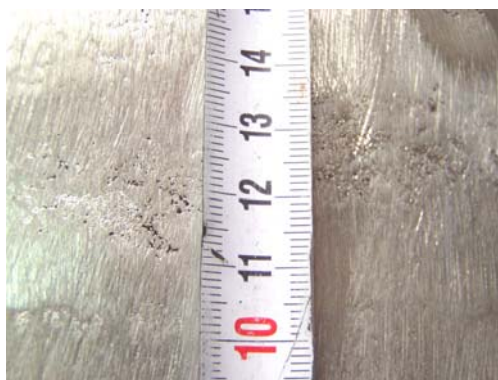
Slika 6 - 8: Poroznost na dijelu površine uzorka torusa
