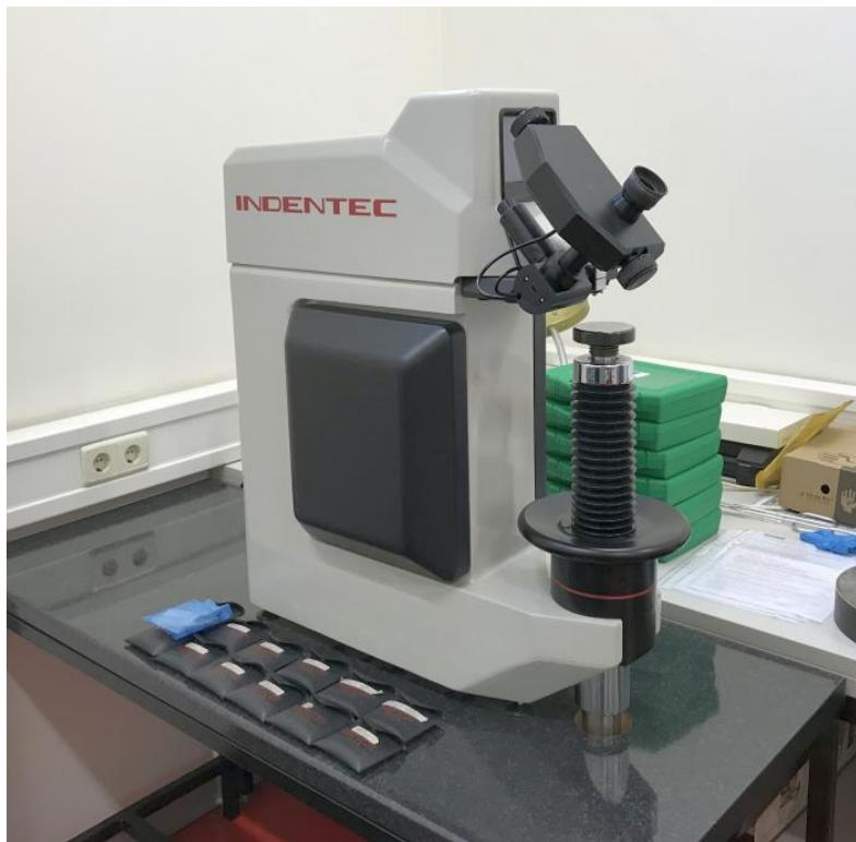
**Slika 5.18 Referentni etalon tvrdoće proizvođača Indentec**
