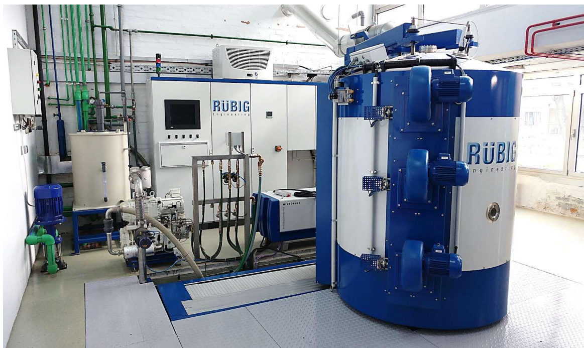
Slika 5.47 Uređaj za PACVD prevlačenje Rübige PC 70/90
