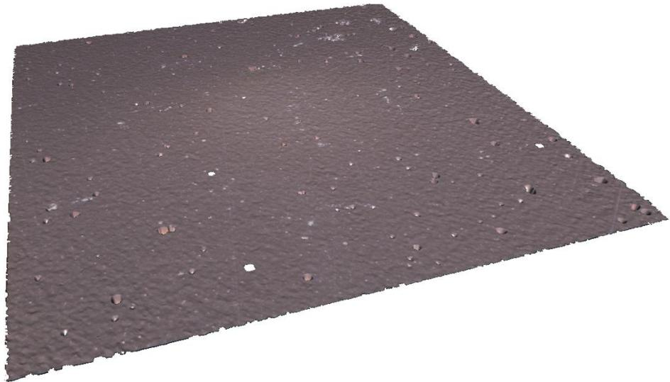
Slika 5.15 Topografija površine uzorka serije SH-5
