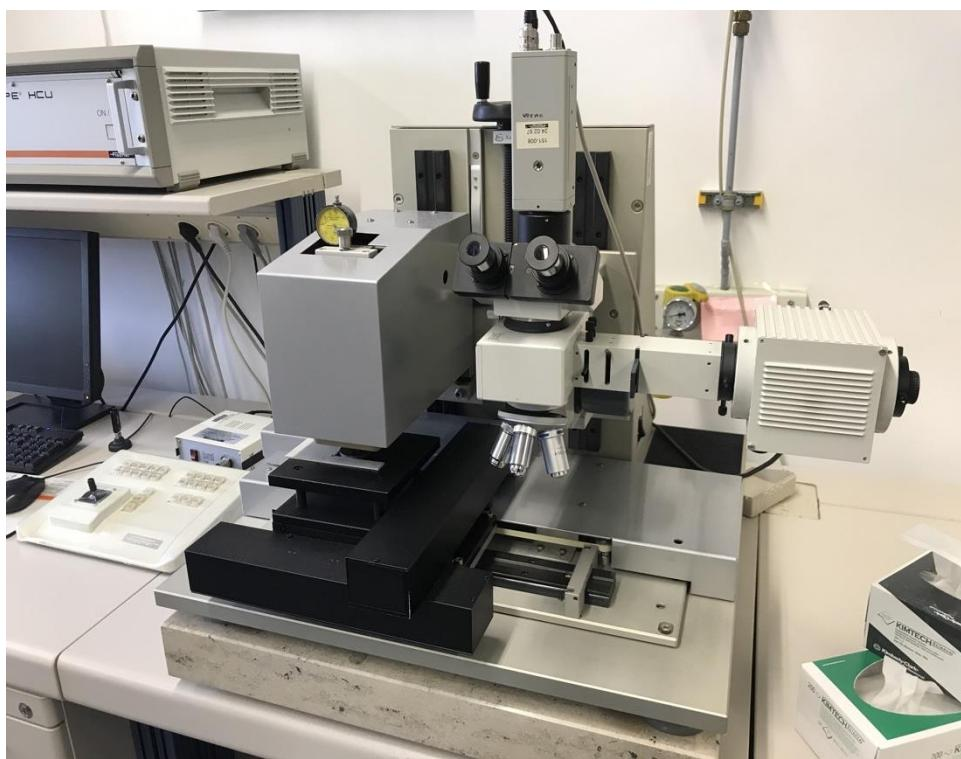
**Slika 5.60 Uredaj za mjerjenje mikrotvrdoće *Fischerscope***
