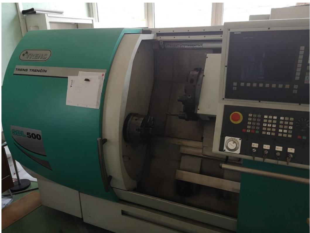
Slika 5.85 Tokarski obradni centar SBL 500
