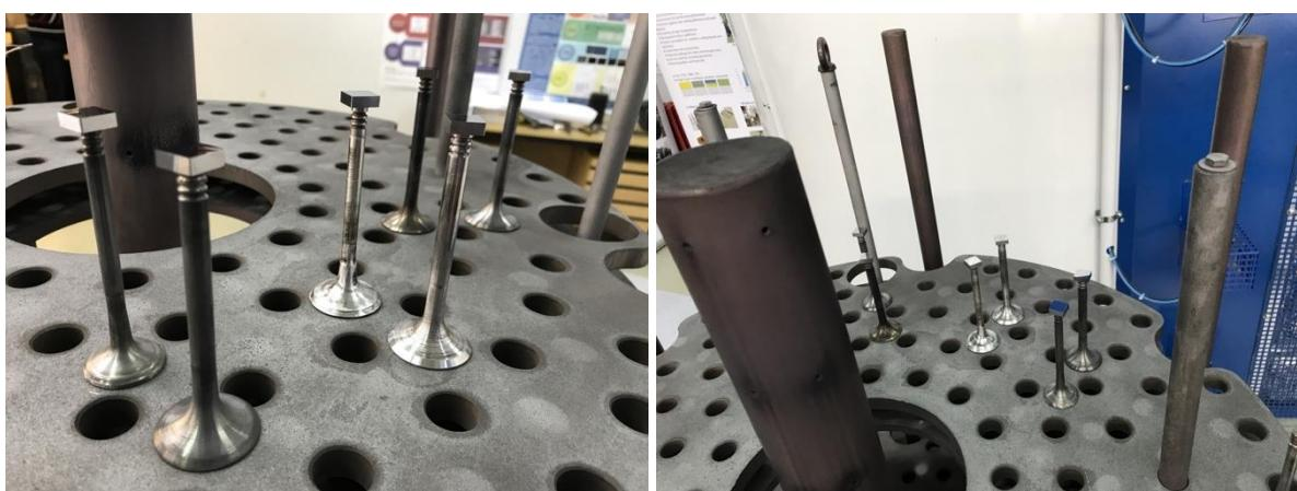
Slika 5.48 Pozicioniranje uzoraka unutar komore za prevlačenje
