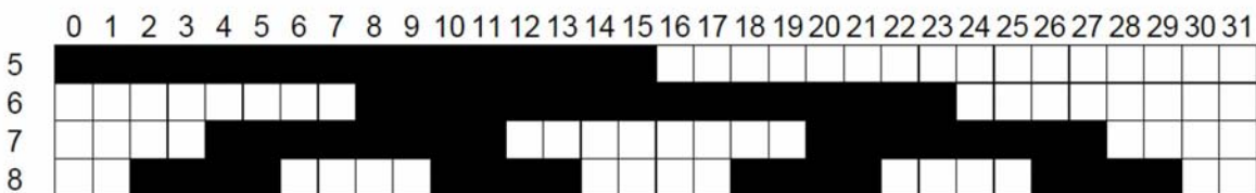
Slika 26: Princip metode Gray koda
