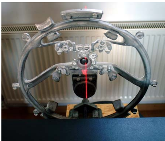
Slika 54. Detalj digitalizacije udubljene strane
