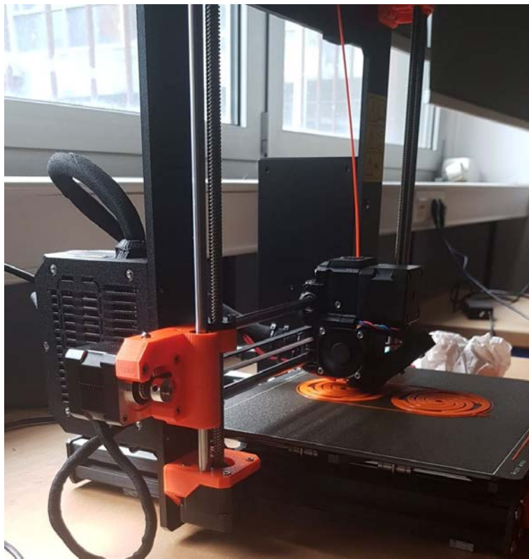
Slika 5.3 Proces ispisa dijelova
