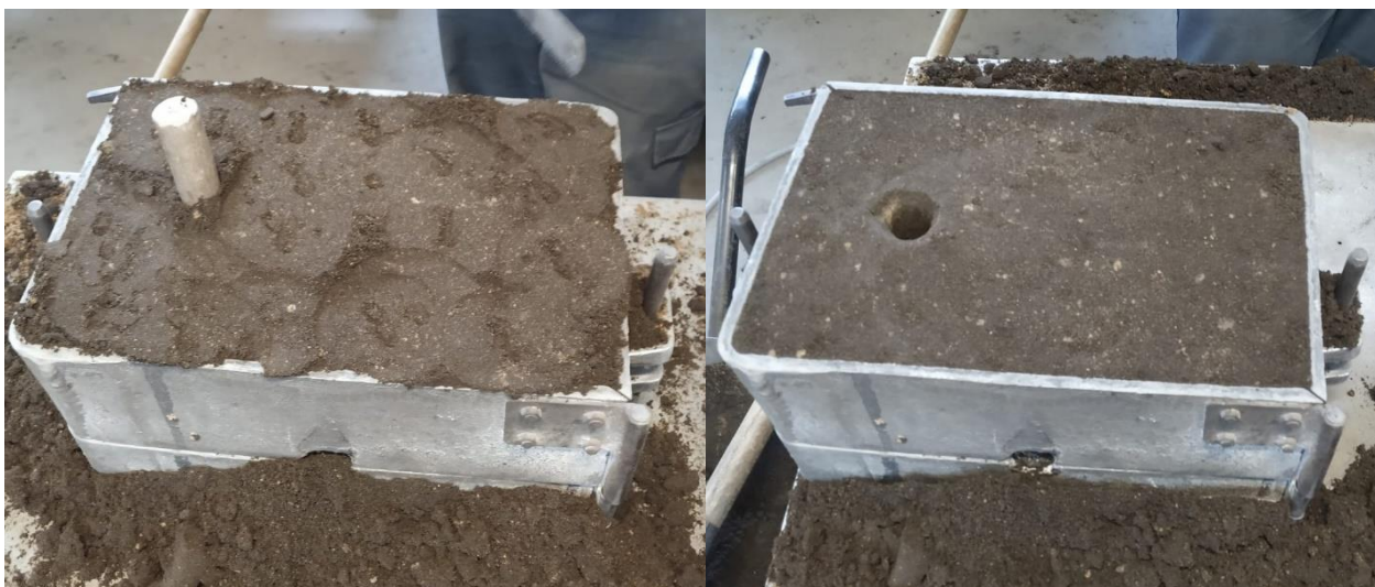
Slika 39. Sabijanje kalupne mješavine i vađenje modela pojila
