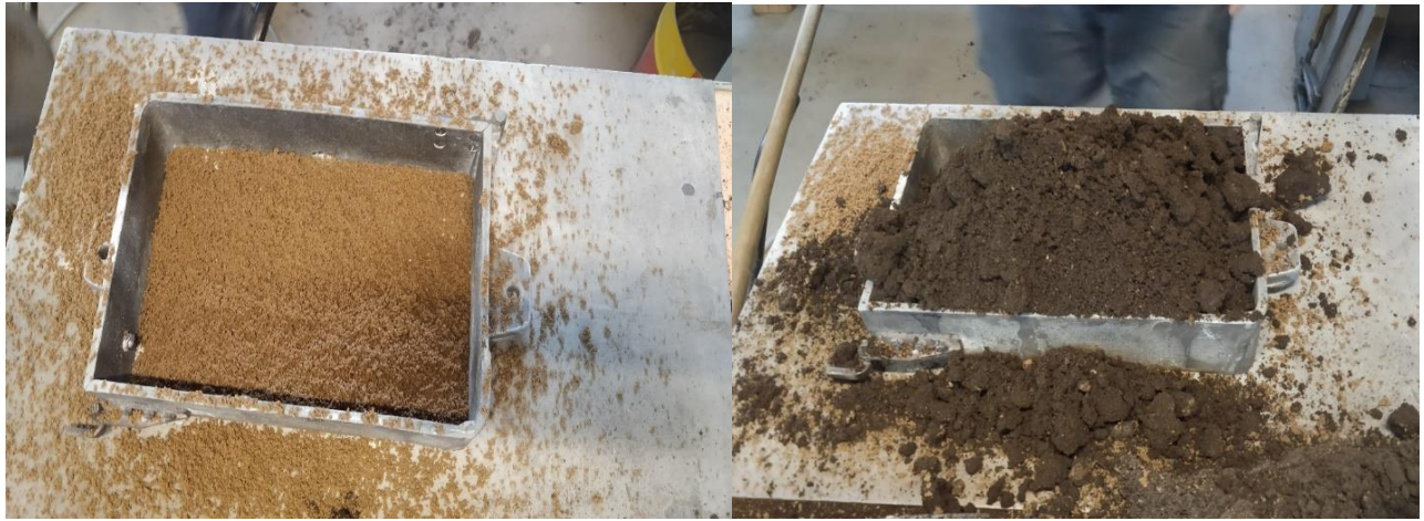
Slika 35. Dodavanje modelne i punidbene kalupne mješavine
