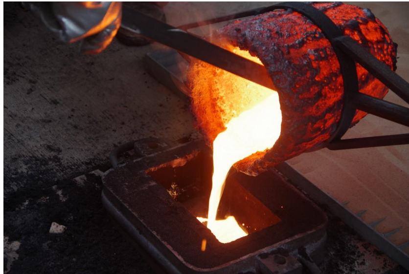
Slika 6. Primjer ulijevanja litine u jednokratni pješčani kalup [10]
