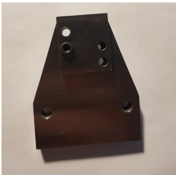
Slika 61. Dva dijela spojena vijkom
