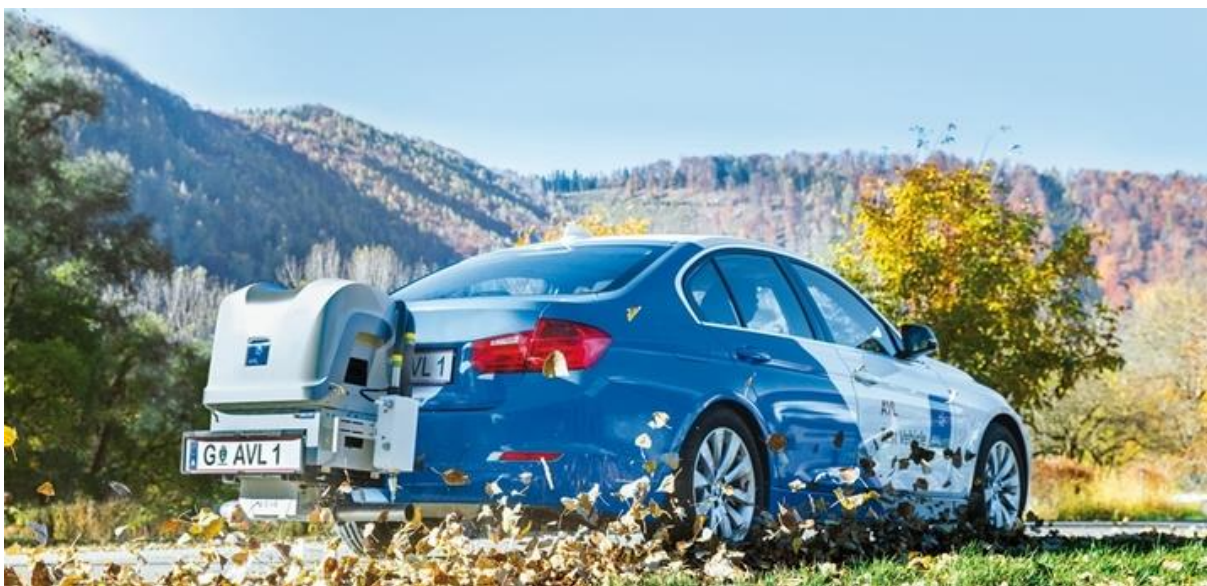
Slika 11. PEMS uređaj tvrtke AVL ugrađen na vozilo [6]
