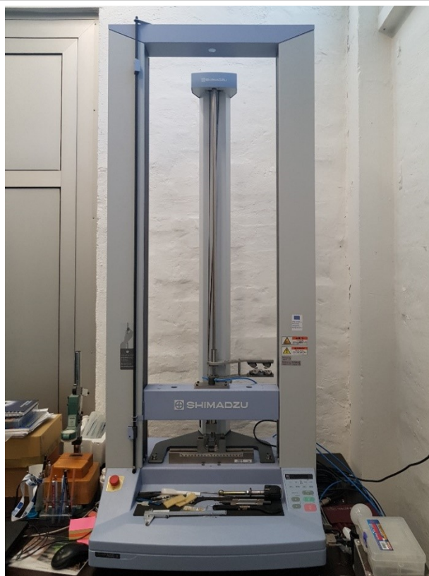
Slika 15. Kidalica u laboratoriju za prerađu polimera FSB-a
