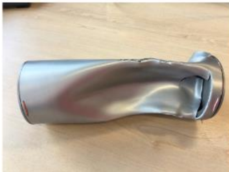
Slika 2.1. Uništeni aluminijski tank na 1000m dubine [4]
