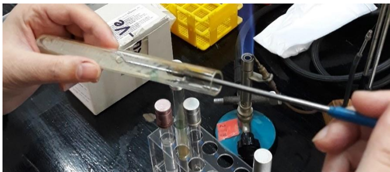
Slika 37. Uzimanje mikroorganizma mikrobiološkom ušicom
