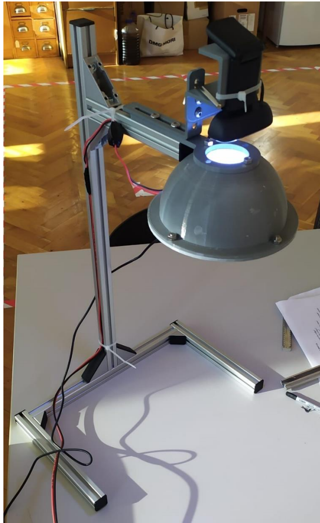
Slika 18. Nosač s kupolnim svjetlom i kamerom
