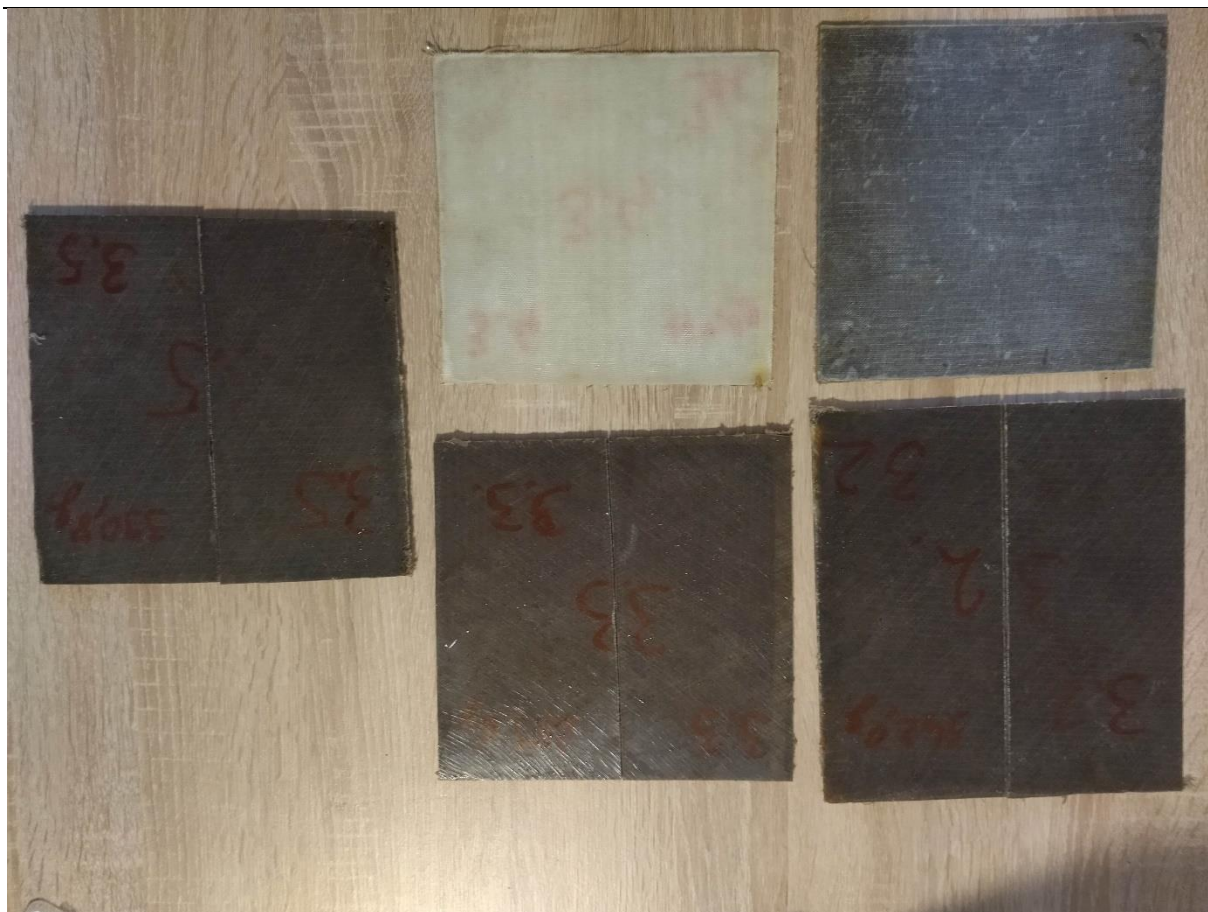
Slika 10. Prikaz uzoraka za ispitivanje upojnosti
