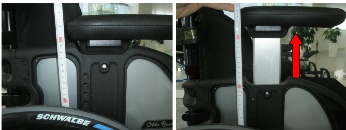
Slika 12 Naslon za ruke koji kod modela 5 omogućuje brzu i jednostavnu promjenu visine naslona za ruke te velik broj mogućih visina naslona za ruke
