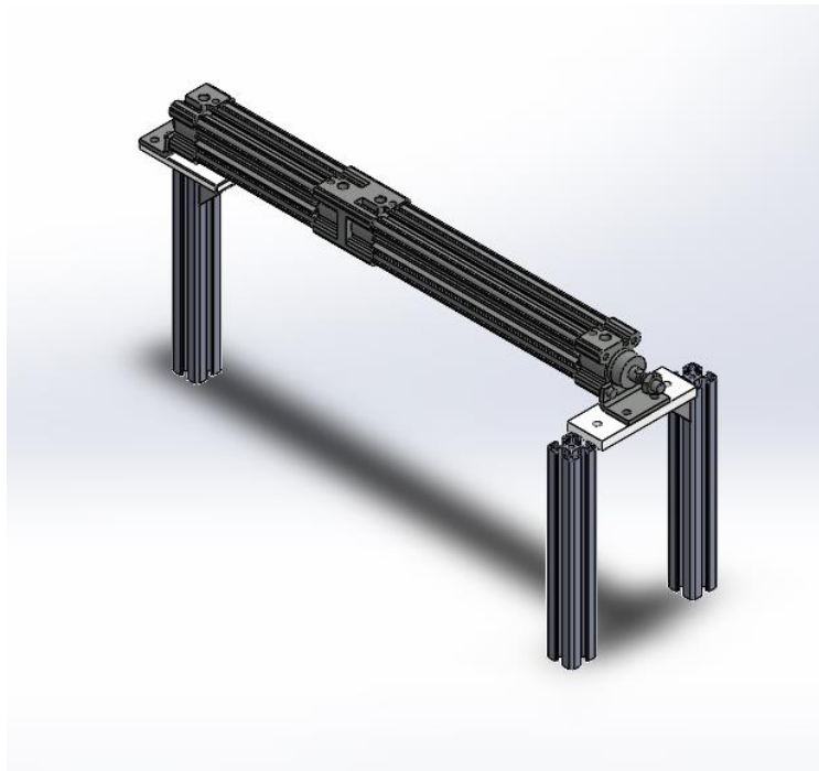
Slika 3.18 Spoj pneumatskog cilindra i potporne konstrukcije
