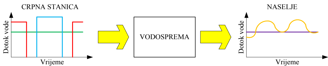
Slika 10. Shematski prikaz režima ulaza i izlaza vode iz vodospreme (Đurin, 2014)
