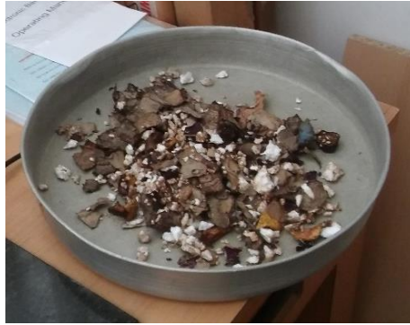
Slika 14. Dio uzorka za ispitivanje vlažnosti – nakon sušenja
