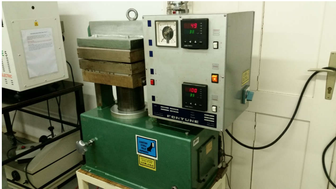
Slika26 - Hidraulička preša Fontune
