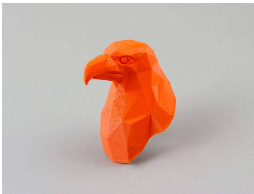
Slika10 - 3D objekt dobiven 3D printerom s PLA filamentom
