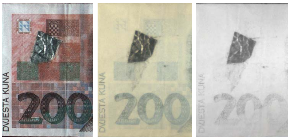
Slika 69 Detalji krivotvorine od 200 kuna, oznake 533, pod imitacijom bijelog svjetla i infracrvenim svjetlom od 715 i 830 nm
