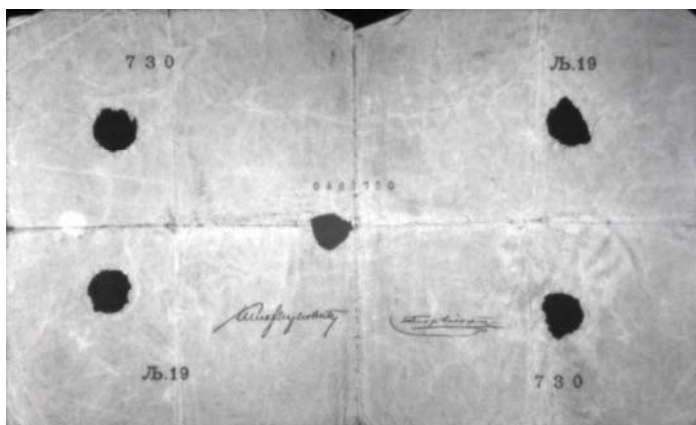
Slika 12 Komparacija odaziva boja pod različitim valnim duljinama srpske novčanice iz 1893.godine, inv.br. 1465. Bijelo svjetlo s opcijom N (A), IR svjetlo od 715 nm(B), 830 nm(C) i 1000 nm(D).
