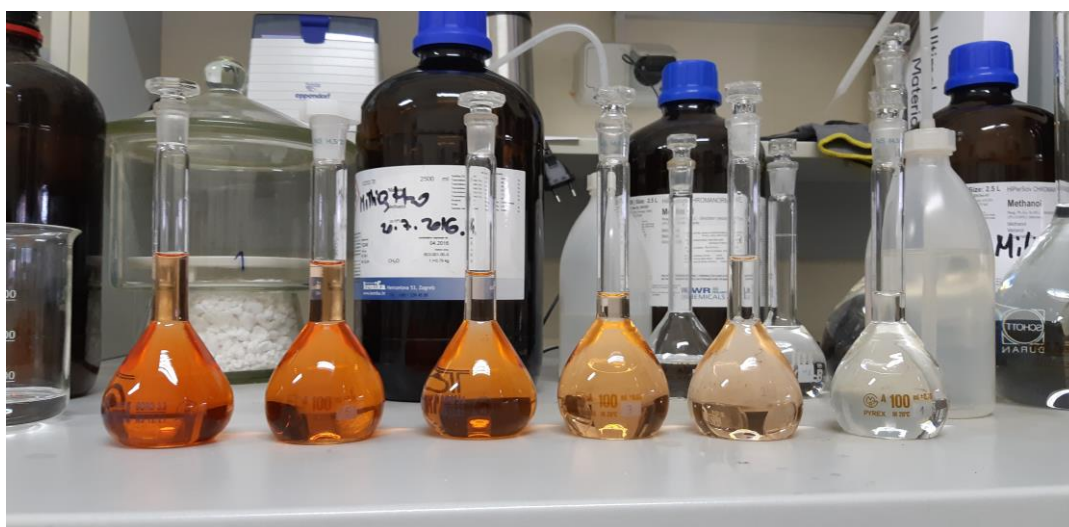
Slika 10. Niz standardnih otopina željeza, s desne strane prema lijevoj u koncentraciji 0; 0,4; 0,8; 2; 2,8 i 4 ppm
