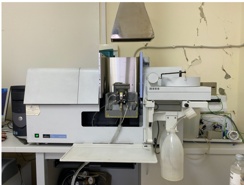
Slika 4. Atomski apsorpcijski spektrometar AAnalyst 800, Zavod za analitičku kemiju
