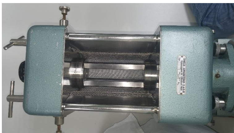
Slika 2.(b) Oscilirajući granulator, pogled odozgo
