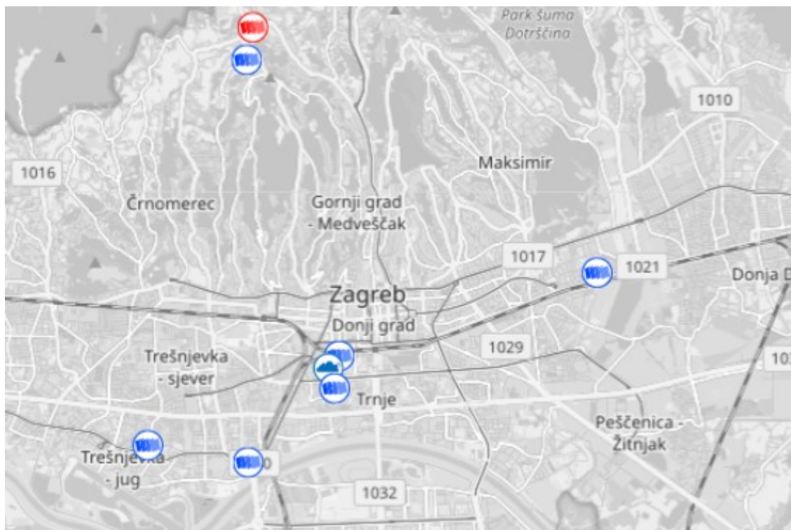
Slika 6.7: Screenshot TTN heatmap-a koji prikazuje dostupne gateway-e na području grada Zagreba
