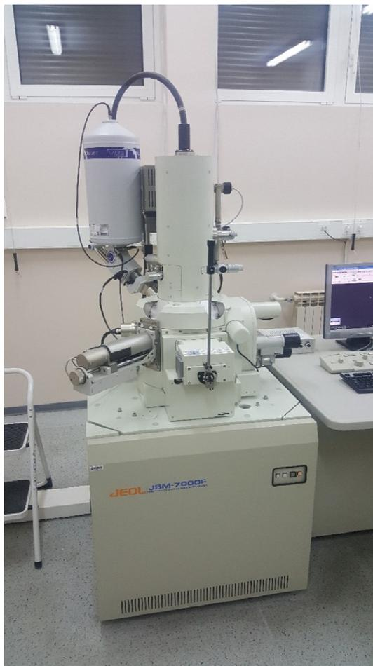
Slika 11. Pretražni elektronski mikroskop *Jeol Ltd. 7000F*
