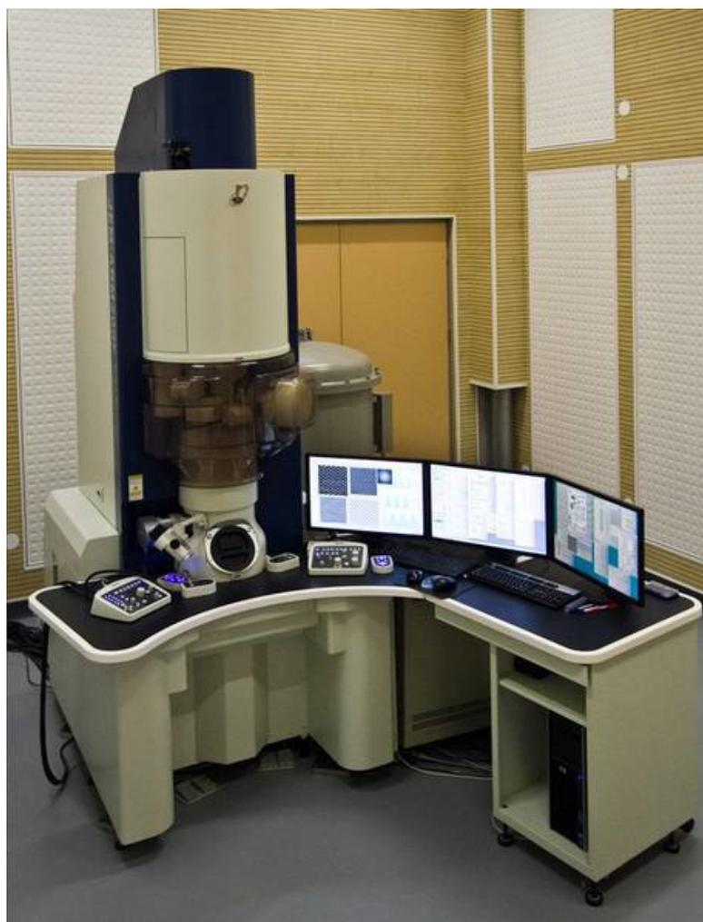
Slika 10. Transmisijski elektronski mikroskop *Jeol ARM 200 CF*<sup>35</sup>
