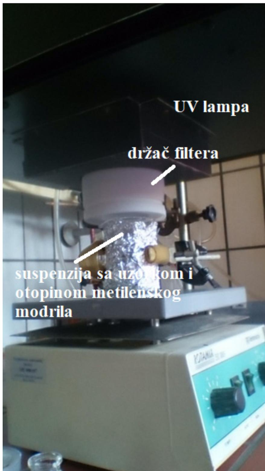
Slika 6. Prikaz postavljenog eksperimenta za određivanje fotokatalitičke aktivnosti
