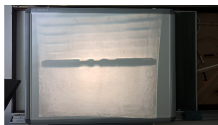
(d) Slika na zastoru. S gornje strane opažamo ravne valove proizvedene titratorom, a s donje difraktirane, kružne valove.
