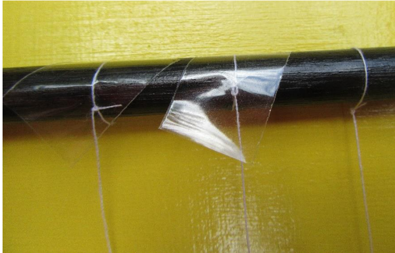
Slika 5.4. Usklađivanje duljine konca ljepljivom trakom.
