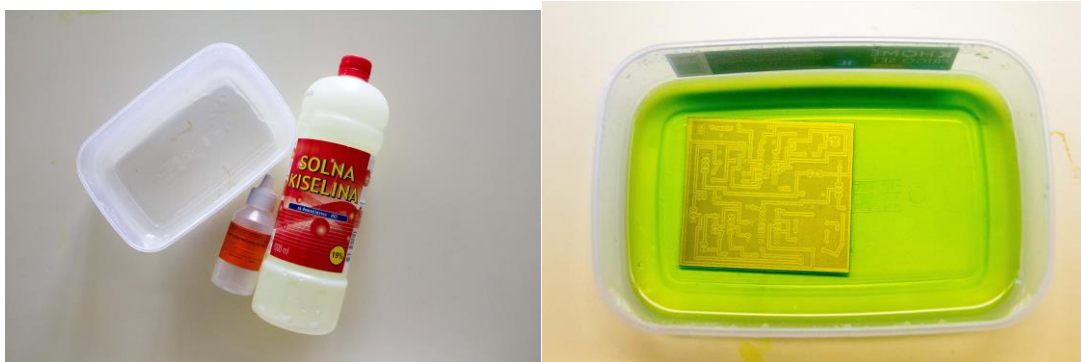
Slika 9 i 10 – Razvijanje pločice u otopini
