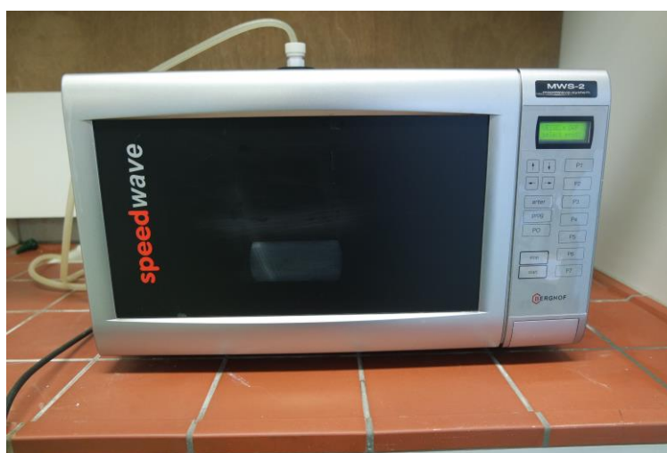
Slika 8. Uređaj za mikrovalno potpomognuto razaranje Microwave System Speedweve Berghof .
