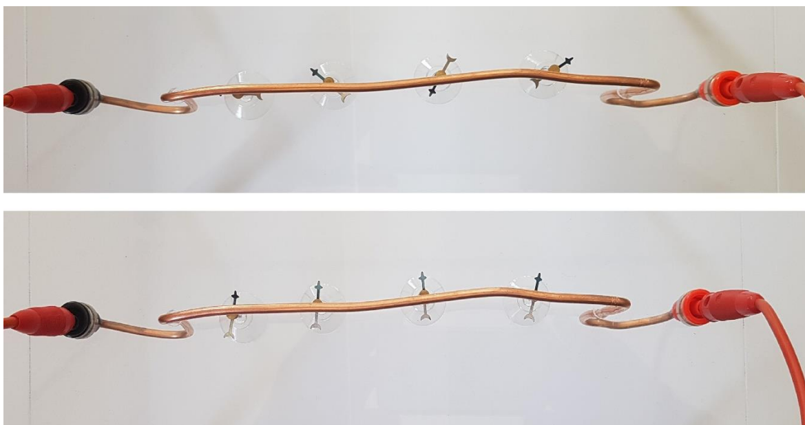
Slika 28 Postav prije puštanja struje kroz vodič (gore), postav za vrijeme prolaska struje kroz vodič (dolje)
