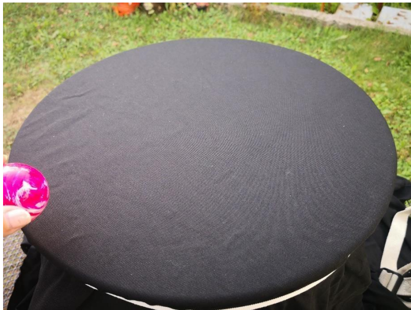
Slika 14: Model trampolina, odnosno zategnute opne koji se koristi za demonstraciju opće teorije relativnosti. Kuglice male mase guramo početnom brzinom u različitim smjerovima. Uočavamo da se one gibaju pravocrtno.
