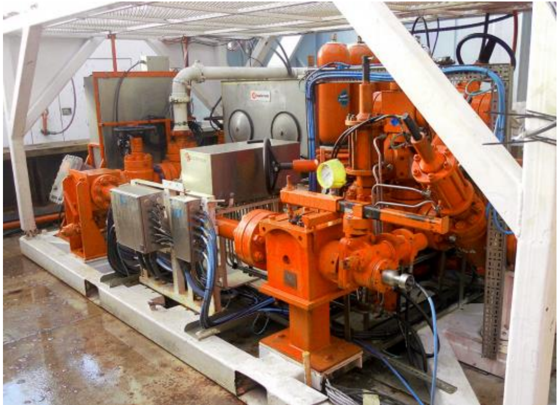
Slika 5-3. Automatizirani razdjelnik podesive sapnice (Reynolds, 2014)
