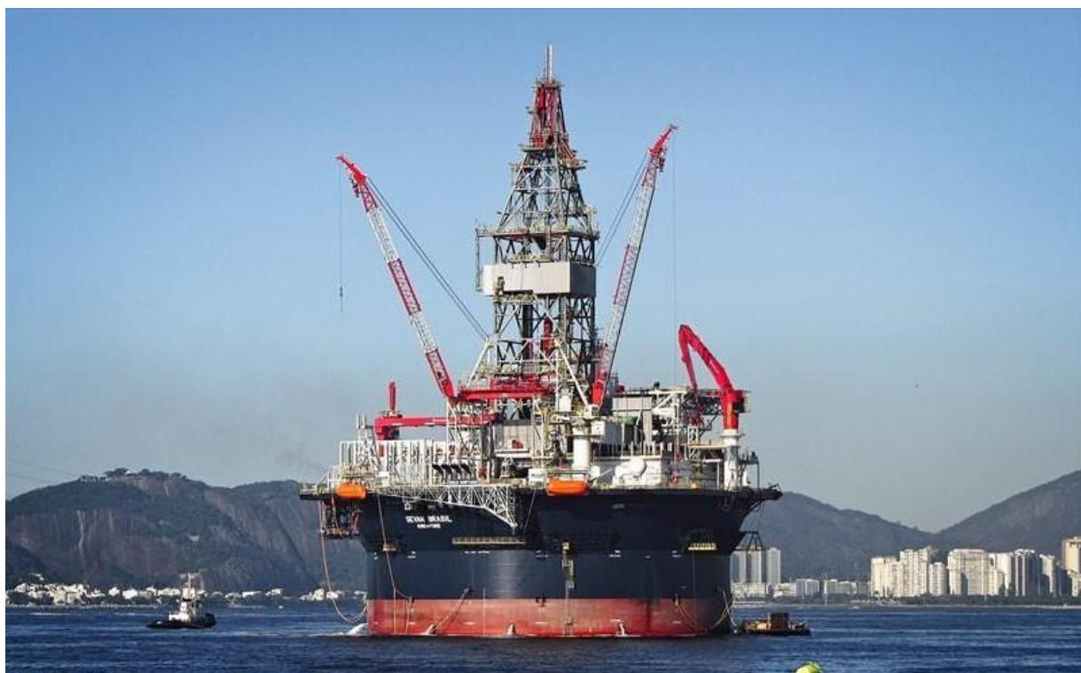
**Slika 4-6.** Poluuronjiva bušaća platforma kružnog oblika ([www.marinetraffic.com](http://www.marinetraffic.com), 2020)
