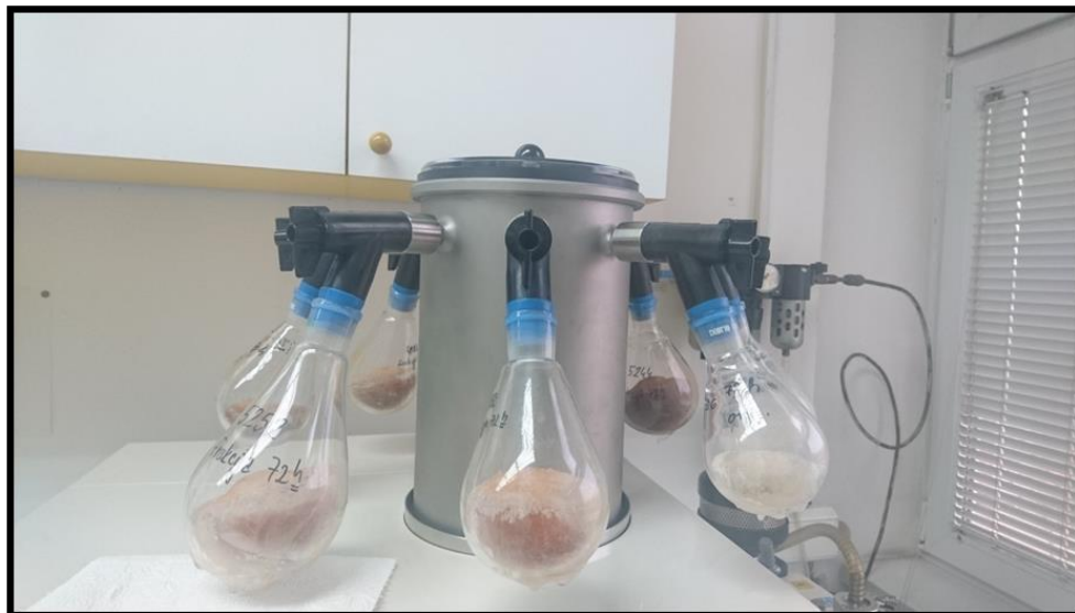
Slika 5-14. Liofilizator (foto: Lucija Mihaljević)
