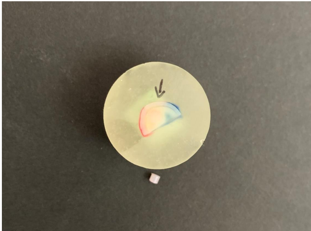
Slika 24. Odlomljeni kompozitni cilindar.
