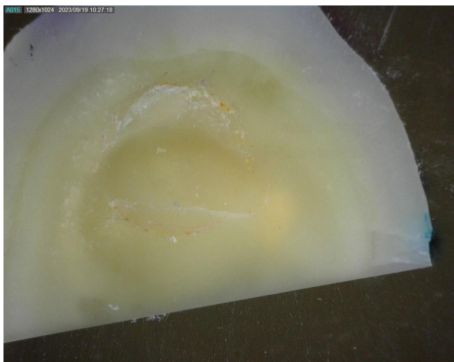
Slika 39. Slika uzorka s mješovitom (dentinskom) frakturom pod digitalnim mikroskopom Dino-Lite .
