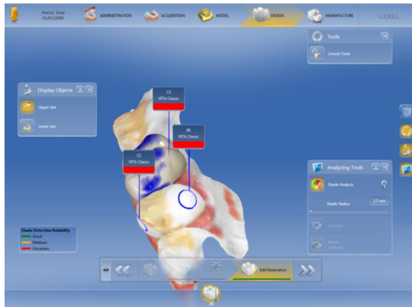
Slika 5. Određivanje boje novim CEREC SW 4.5 softverom.
