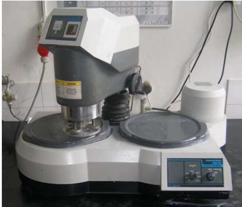
Slika 42. Uređaj za brušenje i poliranje PHENIXBETA GRINDING/POLISHER [38]
