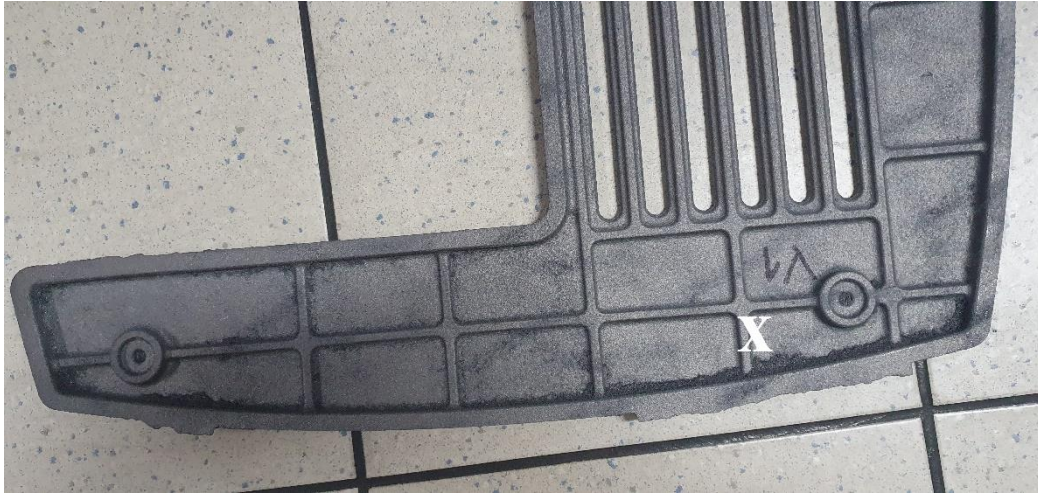
Slika 23. Prikaz zapečenosti u donjem dijelu odljevka
