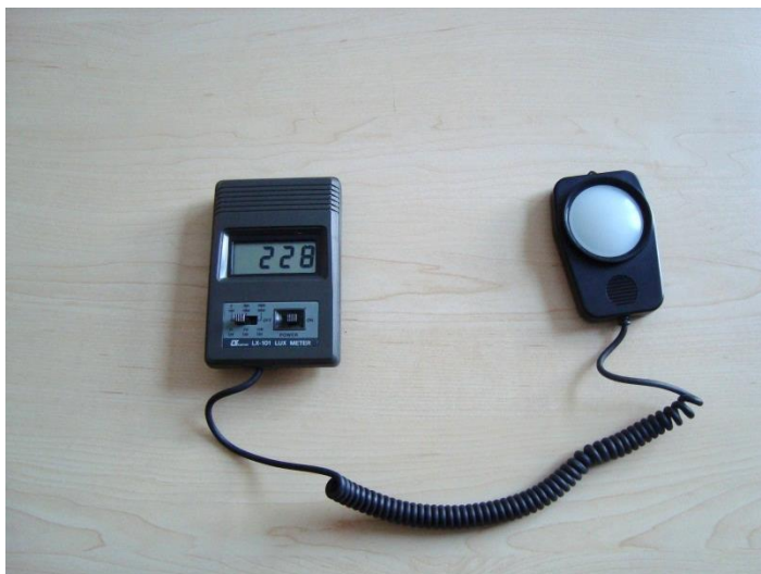
Slika 1: Instrument za mjerenje osvijetljenosti (lx) (snimio: D. Ugarković)
