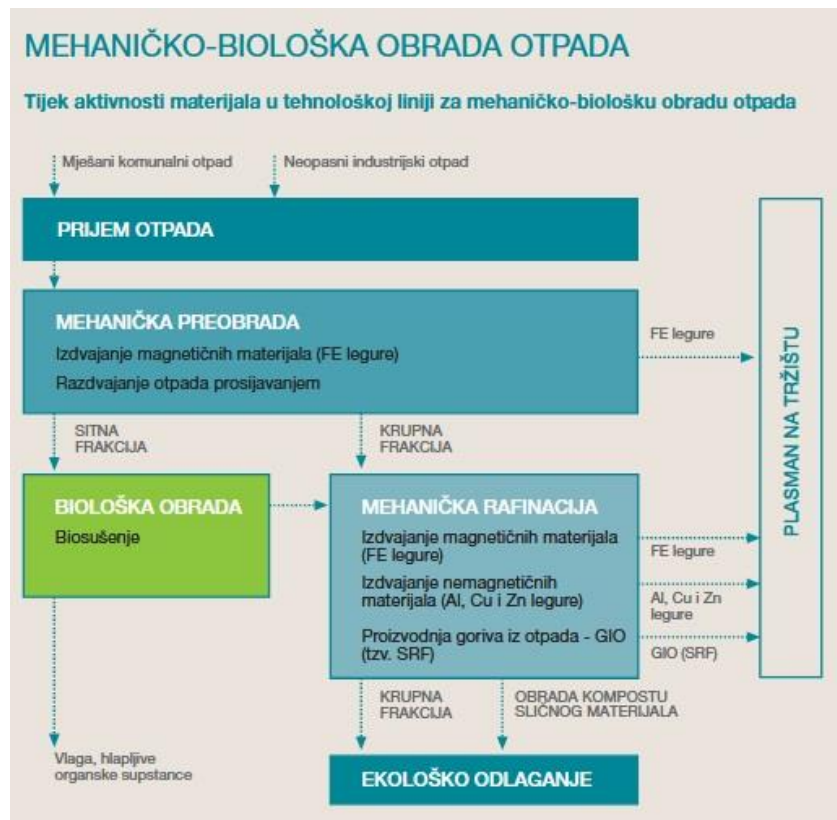
Slika 8. MBO-shema obrade otpada (Izvor: www.ciosmbo.hr )
