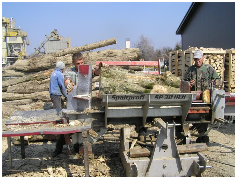
Slika 11. Cjepanje oblice na horizontalnom cjepaču
