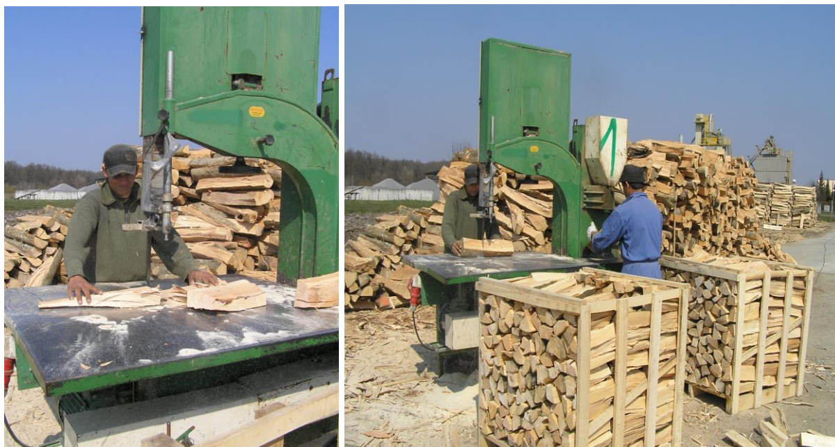
Slika 12. Raspiljivanje cjepanica na kratke komade i eventualno dodatno cijepanje te slaganje u pakete
