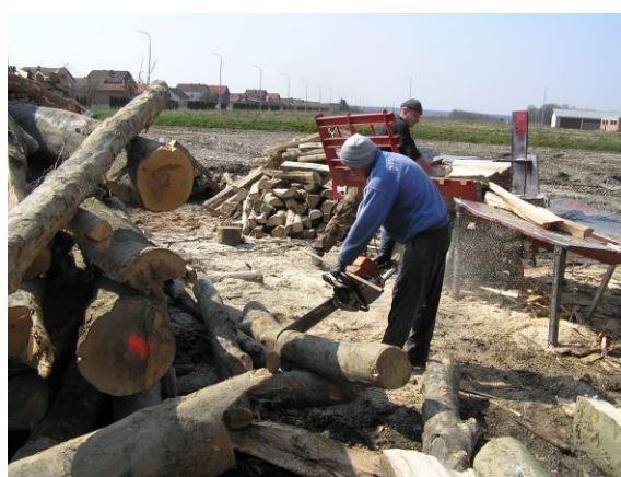
Slika 10. Stovarište višemetrice i prikrajčivanje na metražu
