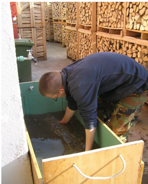
Slika 25. Mjerenje volumena cjepanica volumetrijskom metodom
