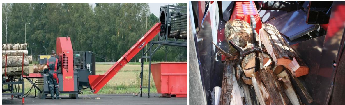
Slika 14. Automatski stroj za piljenje i cjepanje višemetrice
