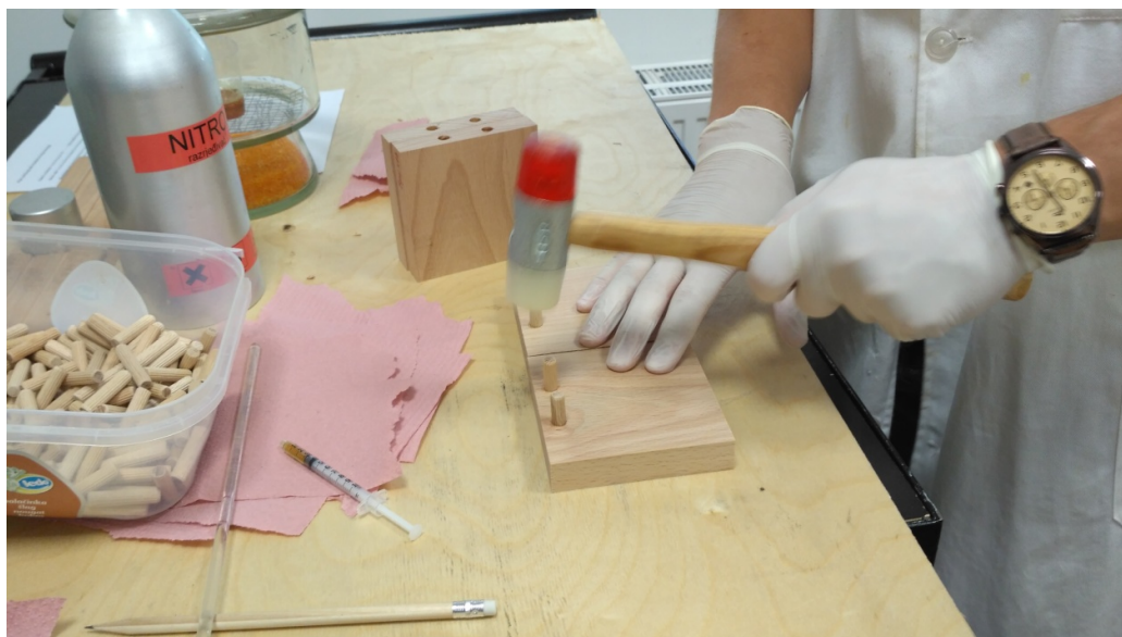
Slika 3. Postavljanje moždanika u plošne rupe
