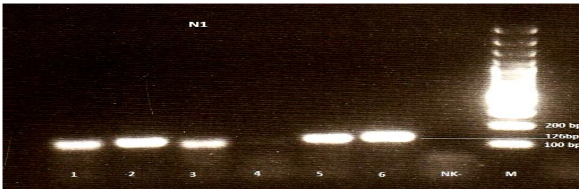
Slika 19. Prikaz rezultata elektroforeze umnoženih odsječaka gena NA veličine 126 bp u 1,5%-tnom agaroznom gelu. M-standard za određivanje molekularne mase (100bp DNA Ladder, Invitrogen, SAD).Oznake uzoraka: 1=1/2016, 2=3/2016, 3=854/2016, 4=631/2016, 5=1600/2012, 6=2319/2011 (PK+)
