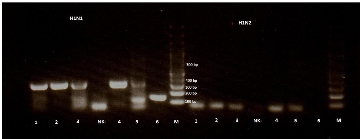
Slika 16. Prikaz dijela rezultata elektroforeze umnoženih odsječaka gena HA u 1,5%-tnom agaroznom gelu. Dobiveni odsječci veličine su 327 bp, početnice prema radu (CHIAPPONI, i sur., 2012.). M-standard za određivanje molekularne mase (100bp DNA Ladder, Invitrogen, SAD). Oznake uzoraka: 1=1/2016, 2=3/2016, 3=5/2016, 4=2319i/2011 (PK+), 5=854/2016, 6=855/2016
