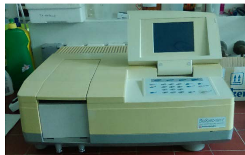
Slika 3.1.5. Shimadzu BioSpec-1601 E UV- Vis spektrofotometar
