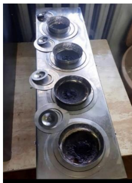
Slika 14: Određivanje pepela u vinu Izvor: Osobni arhiv
