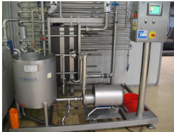
Slika 4. Prikaz pločastog pasterizatora (Izvor: Vlastita fotografija)
