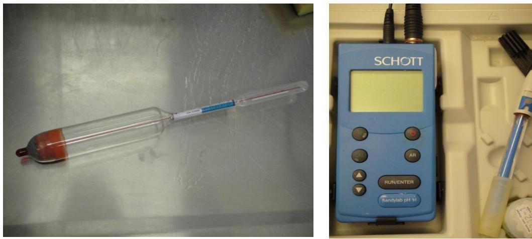
Slika 3. Prikaz uređaja za mjerjenje fizikalnih svojstava mlijeka: laktodenzimetar i pH metar
