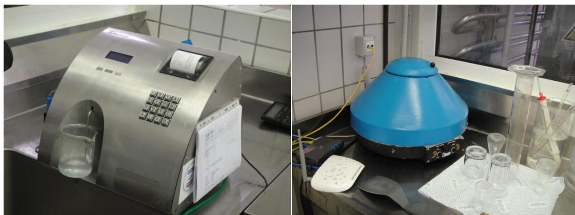
Slika 2. Prikaz mjernih uređaja: Lactoscan i Gerberova centrifuga
