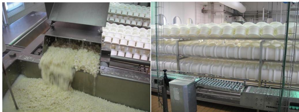
Slika 6. Prikaz izdvajanja sirutke i sirne mase, te procesa prešanja sira
