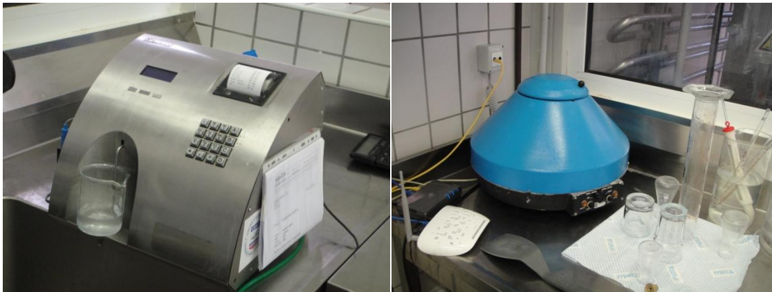
Slika 2. Prikaz mjernih uređaja: Lactoscan i Gerberova centrifuga
