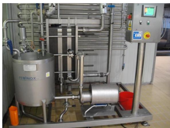
Slika 4. Prikaz pločastog pasterizatora (Izvor: Vlastita fotografija)
