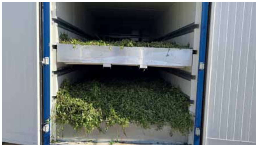
Slika 4. Unutrašnjost prijenosne kondenzacijske sušare
