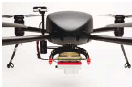
Slika 7. RTK senzor ugrađen na bespilotnoj letjelici
